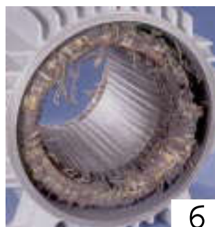
Winding damaged due to overload Quema por sobrecarga Verbrannt wegen Überlast
