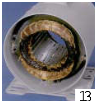
Auxiliary coil damaged Quema en la bobina auxiliar Hilfswicklung verbrannt
