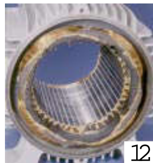
Phase damage due to unbalanced supply voltage Fase dañada por desbalanceo de tensión de la red Beschädigte Phase wegen Phasensymmetrie
