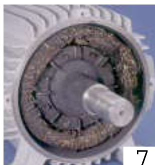
Damage caused by locked rotor Quema por rotor trabado Verbrannt wegen blockiertem Läufer
