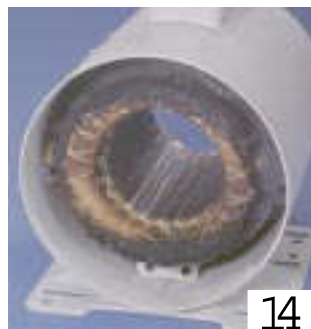
Main coil damaged Quema en la bobina principal Hauptwicklung verbrannt
