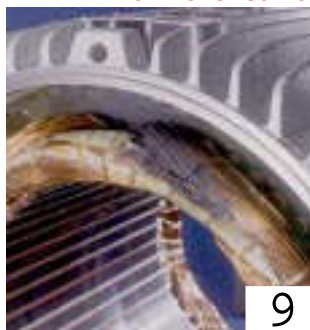
Winding shorted phase-to-phase Corto entre fases Kurzschluss zwischen Phasen
