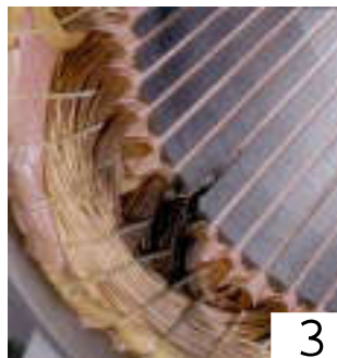
Winding grounded at the edge of slot Corto contra masa en la salida de la ranura Kurzschluss wegen Köperschluss an der Nutöffnung
